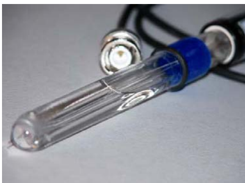
DPST redox electrode type PtEJ 212
